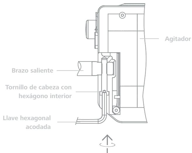
Asegúrese de que el brazo saliente esté bien sujeto. Si se producen vibraciones, el tornillo puede aflojarse. Así pues, por motivos de seguridad, es conveniente comprobar de vez en cuando que el brazo esté firmemente fijado. En caso necesario, vuelva a apretar el tornillo de cabeza con hexágono interior.
