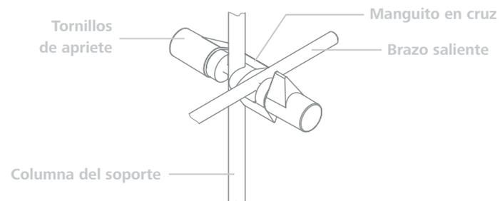
Antes de cada puesta en servicio, así como a intervalos periódicos, asegúrese de que el agitador esté firmemente sujeto. La posición del agitador solo puede modificarse cuando el aparato está parado y desenchufado de la red.
