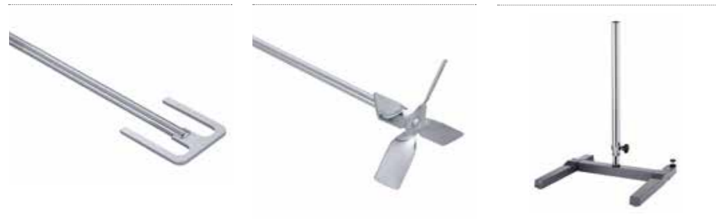
R 1330 锚式搅拌桨 锚式搅拌桨。产生切向流动，边缘形成高剪切率。使混合介质不易沉积在容器壁上。低速使用。应用于聚合物反应及液体中矿物质的分散，是中高粘度介质的理想搅拌桨。 订货号 0002022300
