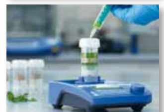
Ejemplo: Homogeneización de hojas de menta con una extracción posterior de muestras
