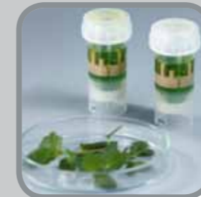
Schritt 8 Versuchsergebnis: Die Minze ist homogen dispergiert.
