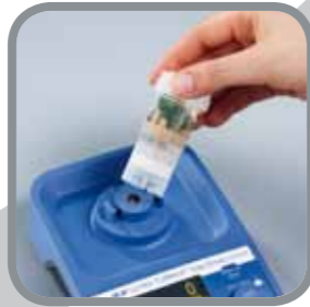
Schritt 3 Das Tube wird auf den Antrieb gesetzt.
