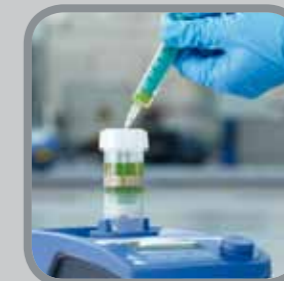
Schritt 9 Bei Bedarf kann die Probe durch eine durchstechbare Deckelmembran mit einer Spritze zur Analyse entnommen werden.
